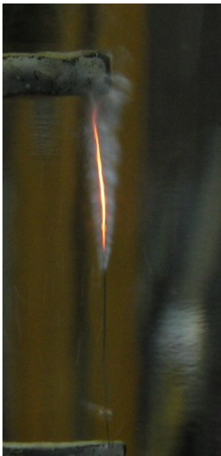
Рис. 1.39. Фотографии переходного от пузырькового к пленочному режиму кипения воды на проволочном нагревателе. (а) – экспозиция – 0.1с, (б) – 0.001с.
