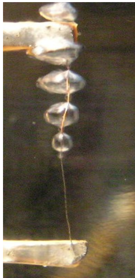
Рис. 1.39. Фотографии переходного от пузырькового к пленочному режиму кипения воды на проволочном нагревателе. (а) – экспозиция – 0.1с, (б) – 0.001с.
